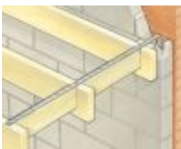
Taśma M305 mocowana do belek wzdłużnych. Uwaga: przerwy między belkami muszą być wypełnione drewnianymi przewiązkami.
