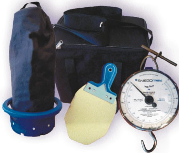
Rys. 6. Śniegomierz przeznaczony do wyznaczania obciążenia dachu zalegającym śniegiem. Na zdjęciu zestaw pomiarowy: torba, zasobnik do pobierania próbek śniegu, łopatką, urządzenie odczytowe
