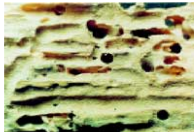
Fot. 2. Chodniki larw po usunięciu mączki drzewnej z odchodami (fot. A.Krajewski)
