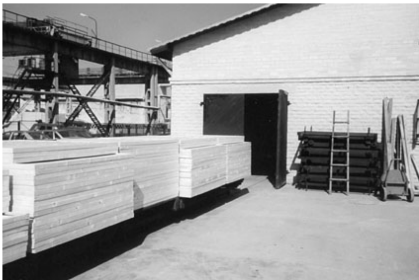
fot.2. Załadowane drewno za chwilę wjedzie do autoklawu.
