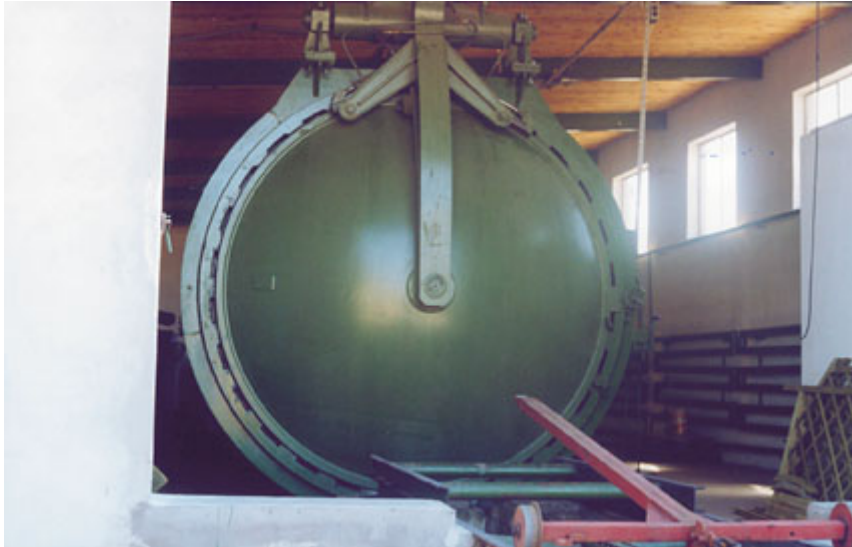
fot.3. Zamknięta pokrywa. W autoklawie odbywa się proces impregnacji.
