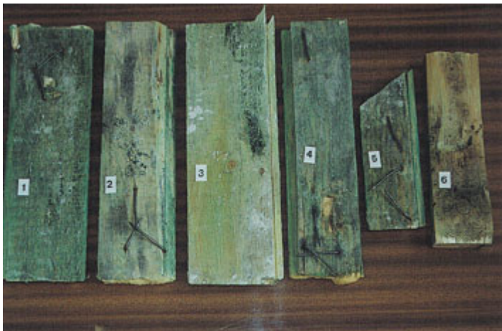
fot. 3. Drewno impregnowane środkiem starszej generacji. Przykład niewłaściwego doboru preparatu. Rozwój pleśni na elementach uprzednio zawilgoconych. Próbkę wymontowane z budynku i przedstawione do oceny mikrobiologicznej.
