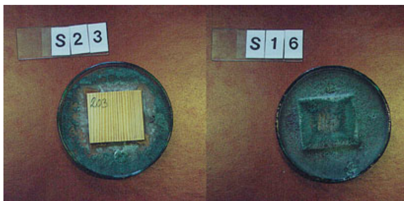
fot. 1. Przykład badań skuteczności zabezpieczenia drewna przed pleśnieniem. Grzyb testowy - Trichoderma viride .
