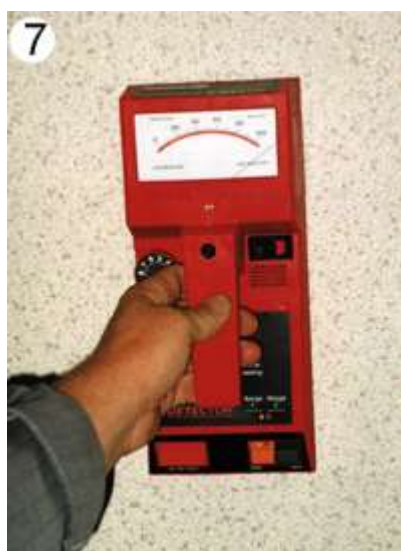
Fot.7. Wet Wall Detector
