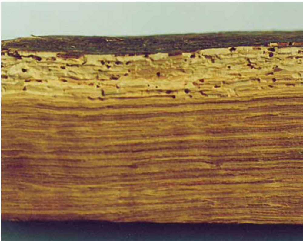
Fot. 4. Kanciak dębowy stoczony przez larwy miazgowca (przekrój w poprzek włókien) - widoczna nienaruszona twardziel.
