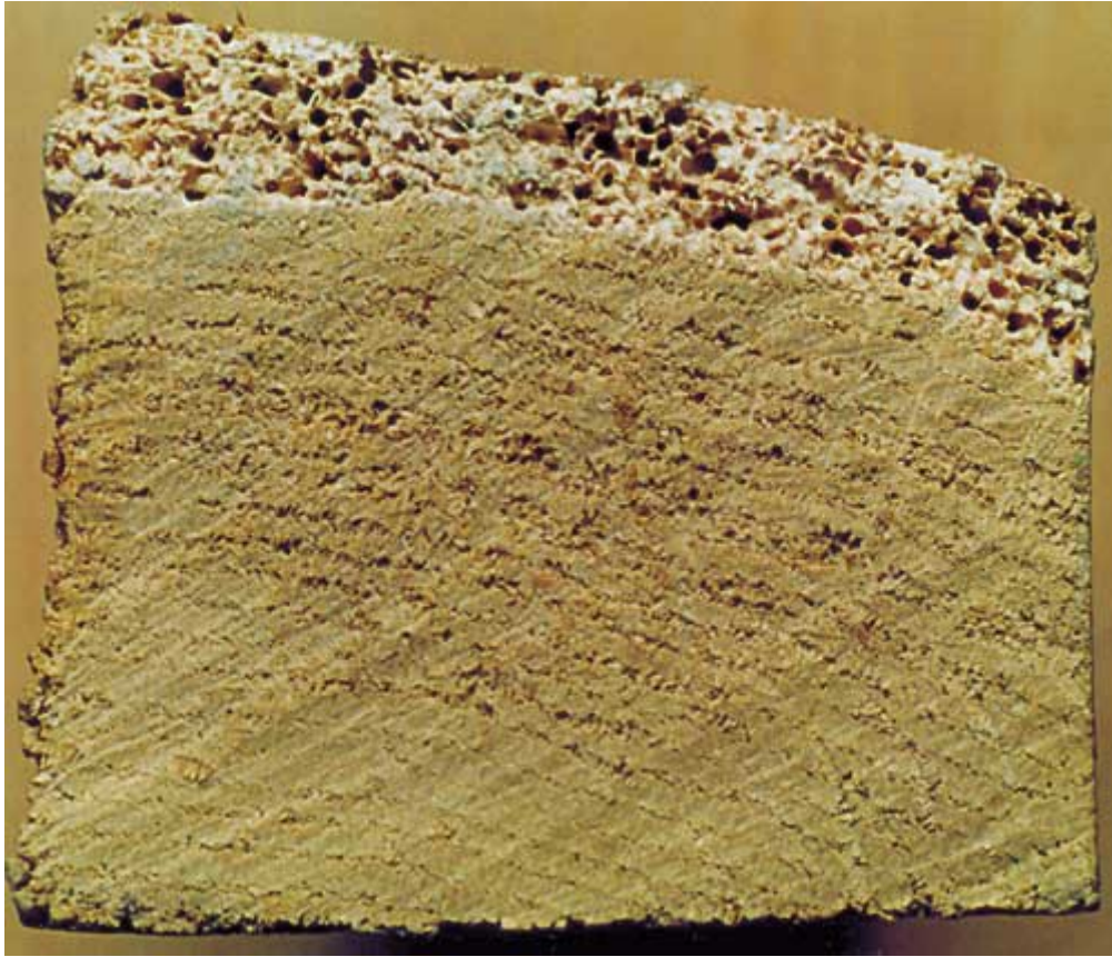
Fot. 4. Kanciak dębowy stoczony przez larwy miazgowca (przekrój w poprzek włókien) - widoczna nienaruszona twardziel.
