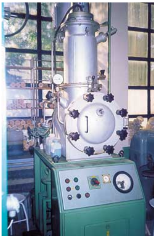
Fot. 5. Laboratoryjny aparat do nasycania drewna metodami ciśnieniowymi. (Fot. B. Mazela)
