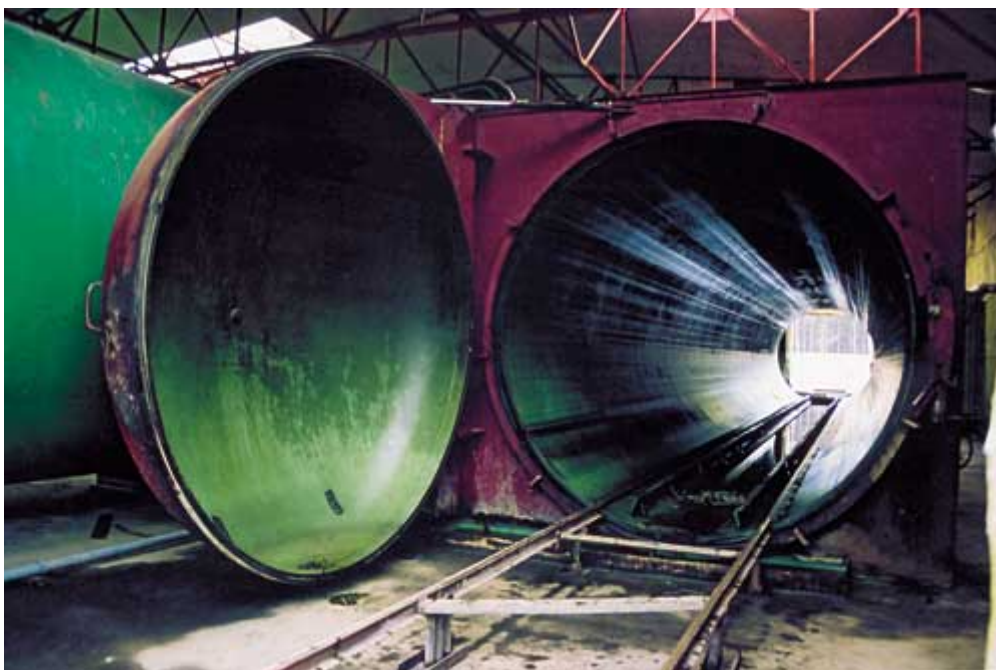
Fot. 1. Przelotowy autoklaw impregnacyjny do przemysłowego nasycania drewna. (Fot. Z. Czajka)
