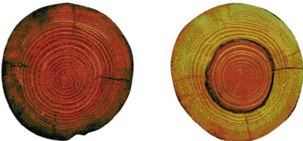
Fot. 3. Przekrój poprzeczny drewna nasycanego w stanie wilgotności 28%. Wchłonięcie preparatu = 7.5 kg/m 3 . (Fot. G. Cofta)
