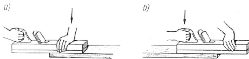
Rys. 55. Sposób ujęcia i prowadzenia spustu: a) początek posuwu, b) końcowa faza posuwu [7, s. 306]
